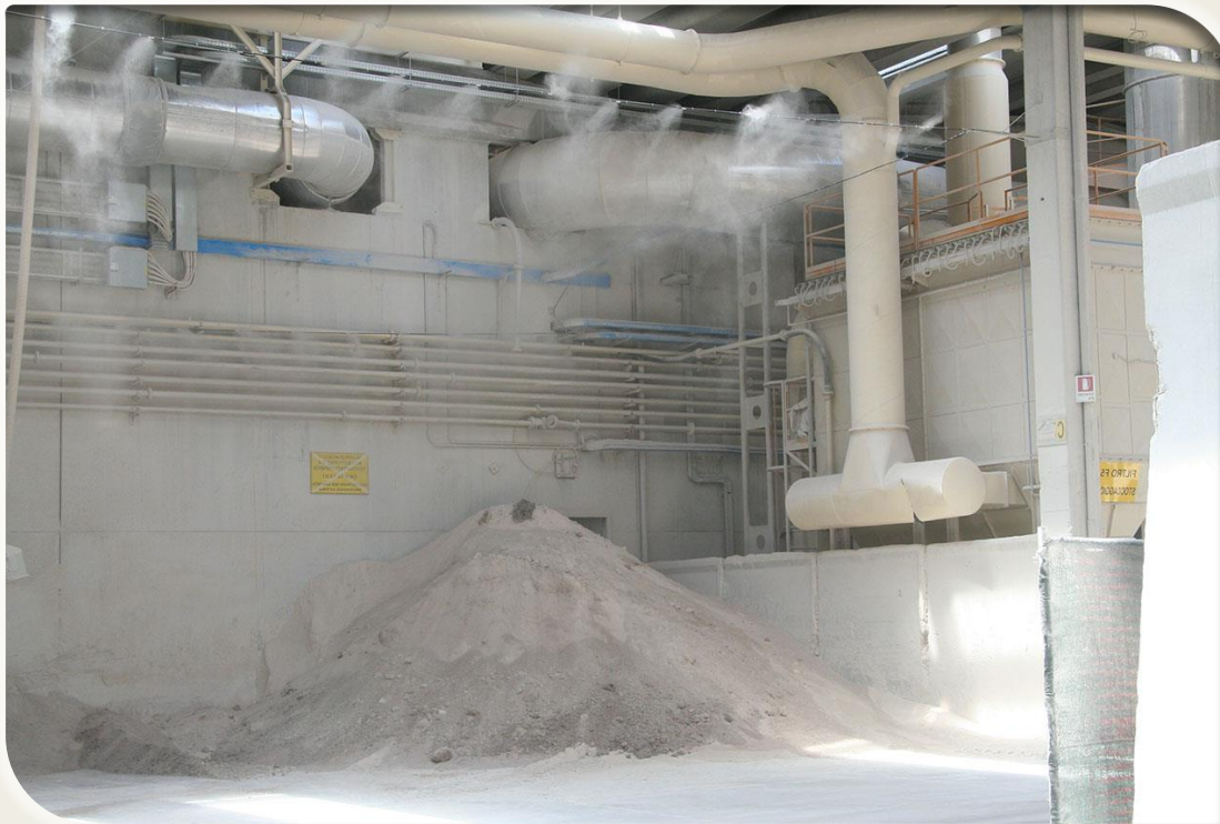
Система тумана в работе на пыльном производстве
